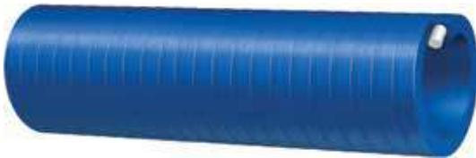
**Aspiration & refoulement d'hydrocarbures - PVC - service sévère****Construction :** PVC bleu- résistant à l'abrasion, l'ozone et les hydrocarbures.**Armature :** PVC blanc rigide et résistant aux chocs.**Utilisation :** l'aspiration et le refoulement de carburants et d'huile, d'usage général.**Températures d'utilisation :** -10 °C +60 °C (+14 °F +140 °F)
