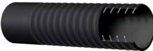
**Aspiration & refoulement d'eau-lisier - ondulé - manchettes souples aux extrémités****Tube :** SBR noir.**Armature :** nappes textiles haute résistance renforcées avec des spirales métalliques en acier.**Revêtement :** SBR noir - résistant à l'abrasion et à l'ozone.**Utilisation :** l'aspiration et le refoulement d'eau. Construction spéciale légère et flexible pour les citernes à lisier.**Températures d'utilisation :** -30 °C +80 °C (-22 °F +176 °F)
