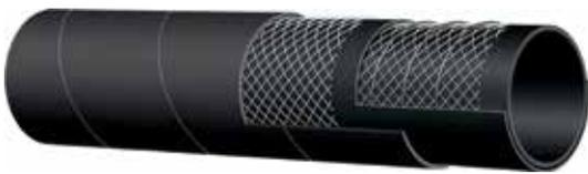
**Aspiration & refoulement de biocarburant 10 bar (150 psi)****Tube :** NBR noir conducteur.**Armature :** nappes textiles haute résistance renforcées avec des spirales métalliques en acier.**Revêtement :** CR noir - résistant à l'abrasion, l'ozone et les hydrocarbures.**Utilisation :** l'aspiration et le refoulement de carburant et d'huile. Spécialement conçu pour le biocarburant et l'éthanol.**Températures d'utilisation :** -30 °C +80 °C (-22 °F +176 °F)
