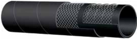
**Aspiration & refoulement d'hydrocarbures 20 bar (300 psi)****Tube** : NBR noir conducteur.**Armature** : nappes textiles haute résistance renforcées avec des spirales métalliques en acier et cordelette anti-statique.**Revêtement** : CR noir - résistant à l'abrasion, l'ozone et les hydrocarbures.**Utilisation** : l'aspiration et le refoulement de carburant et d'huile. Conçu pour une longue durée de vie en service sévère.**Températures d'utilisation** : -30 °C +80 °C (-22 °F +176 °F)
