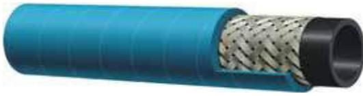
**Refoulement d'eau en haute pression 100 bar (1500 psi) - canon à neige - acier tressé****Tube :** SBR noir.**Armature :** tresses métalliques en acier haute résistance.**Revêtement :** CSM bleu - résistant à l'abrasion et à l'ozone.**Utilisation :** le refoulement d'eau en haute pression.
