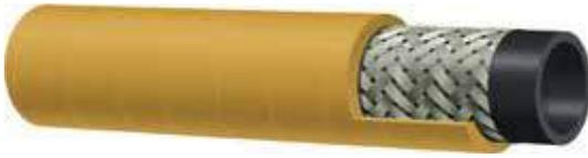
**Air comprimé - acier tressé****Tube :** SBR noir - résistant au brouillard d'huile.**Armature :** une ou deux tresses métalliques en acier haute résistance.**Revêtement :** SBR jaune - résistant à l'abrasion, à l'ozone et aux hydrocarbures - micro-perforé.**Utilisation :** l'air comprimé à haute pression conçu pour les applications minières et de carrières difficiles nécessitant une longue durée de vie et une sécurité maximale.**Températures d'utilisation :** -30 °C +80 °C (-22 °F +176 °F)
