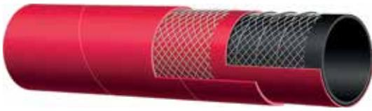
**Aspiration & refoulement d'hydrocarbures 10 bar (150 psi)****Tube :** NBR noir conducteur.**Armature :** nappes textiles haute résistance renforcées avec des spirales métalliques en acier.**Revêtement :** CR rouge - résistant à l'abrasion, l'ozone et les hydrocarbures.**Utilisation :** l'aspiration et le refoulement de carburant et d'huile. Spécialement conçu pour les camions-citernes et les applications industrielles générales.**Températures d'utilisation :** -30 °C +80 °C (-22 °F +176 °F)
